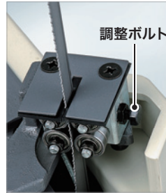
ノコ刃ガイド調整機構 精度の補正が行えます。
