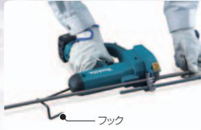
長い全ネジボルトをフックの上のせる事で、安定した切断が行えます。
